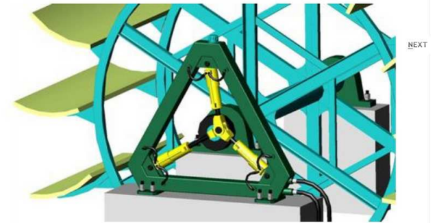
Promieniowa pompa wielotłokowa dla małych elektrowni wodnych Politechnika Poznańska
